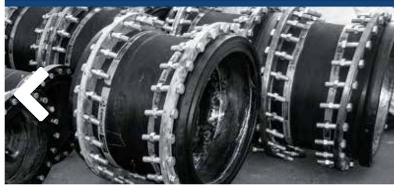
El manguito antivibratorio suelen instalarlo directamente antes o después de la bomba, y se utiliza para reducir la vibración en los sistemas de tuberías lo que disminuye la carga en el sistema y permite evitar las averías en las zonas de conexión entre el ducto de pulpa y la bomba.
